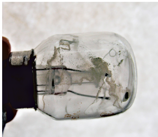
Рис. 8. Лампочка из холодильника, видна конденсация оксида на холодном
