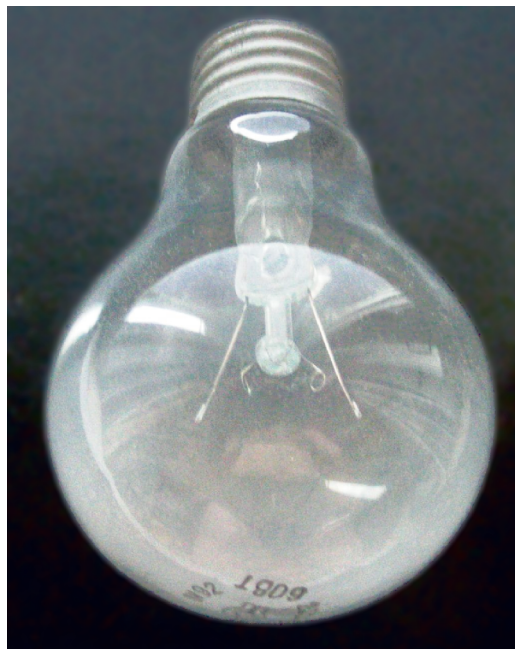
Рис. 3. Баллон с бело-желтым напылением
