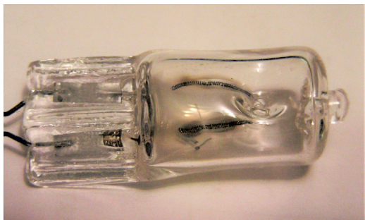
Рис. 5. Галогеновая лампа, нить оборвалась и припаялась к баллону
