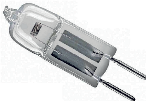
Рис. 9. Галогеновая лампа во всей красе. В кварц впаяны не проволочки, а ленточки из весьма тонкой фольги
