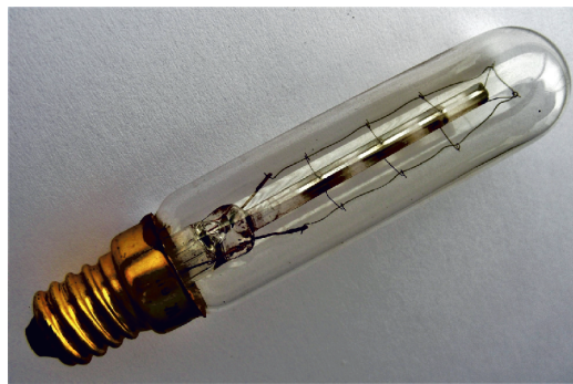
Рис. 7. Молибден, напыленный на стекло
