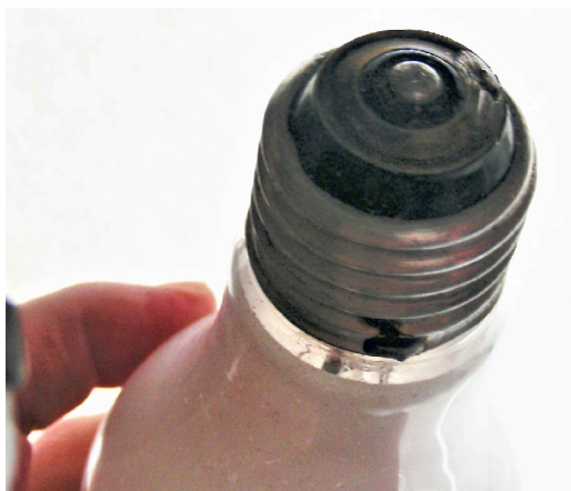
Рис. 12. Лампа накаливания с тремя выводами
