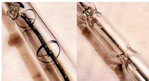
Рис. 10. Галогенки. Слева нить висит на специальных кольцах, спейсерах, а справа обошлись без них
