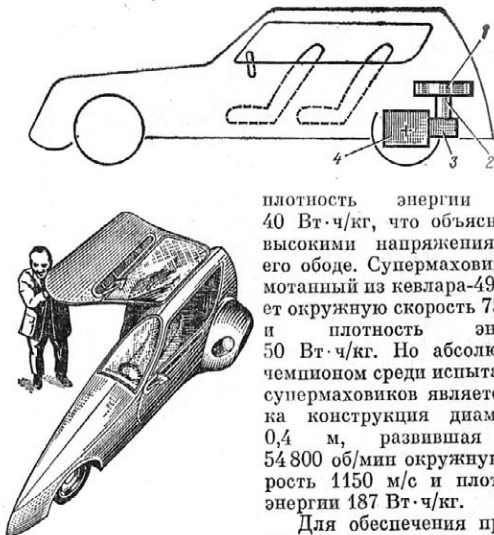
Рис. 25. Схема и общий вид махомобиля Рабенхорста
