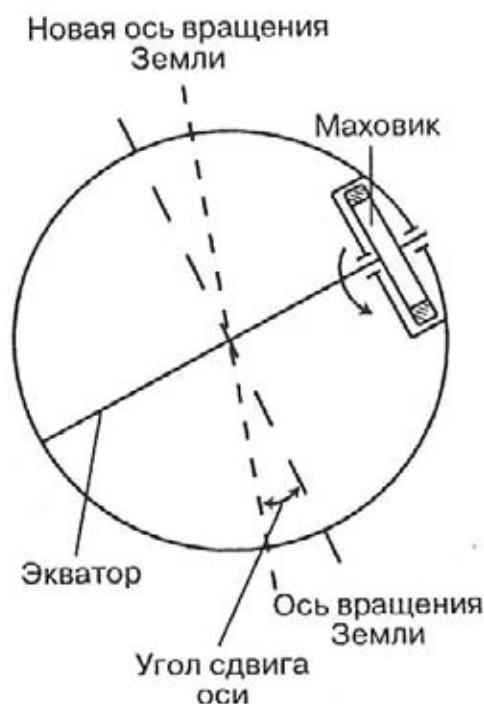
Рис. 36. Схема расположения маховика на Земле для поворота оси Земли
