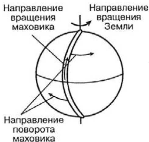
Рис. 13. Схема вращения маховика, «обернутого» вокруг Земли
