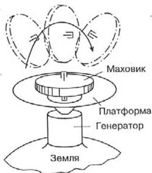
Рис. 37. Маховик на платформе на полюсе Земли
