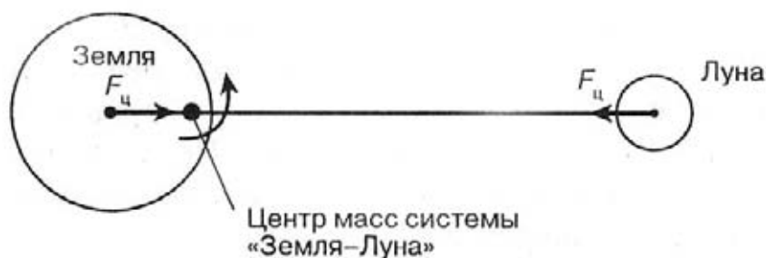
Рис. 7. Схема сил, действующих на систему «Земля – Луна»
