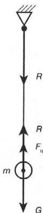
Рис. 4. Схема действия сил в маятнике
