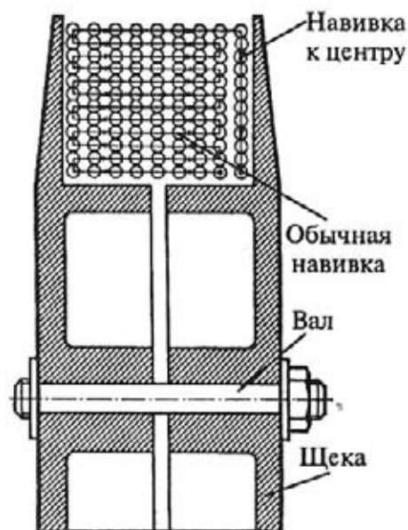
Проволочный супермаховик и принцип его намотки
