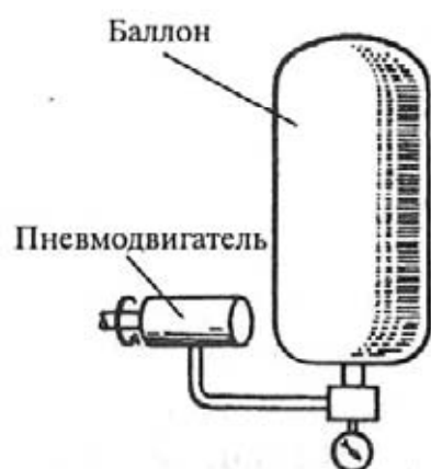
Сжатый газ в баллоне выделяет энергию, вращая пневмодвигатель
