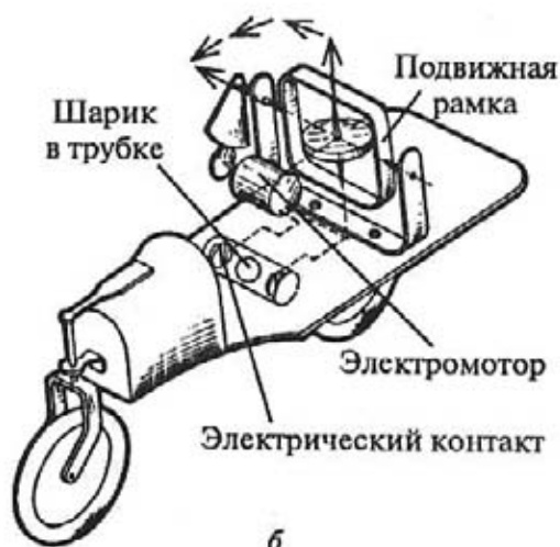
Гирокар П. П. Шиловского (а) и принцип его действия (б)
