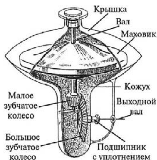
Инерционный аккумулятор А. Г. Уфимцева с механическим приводом
