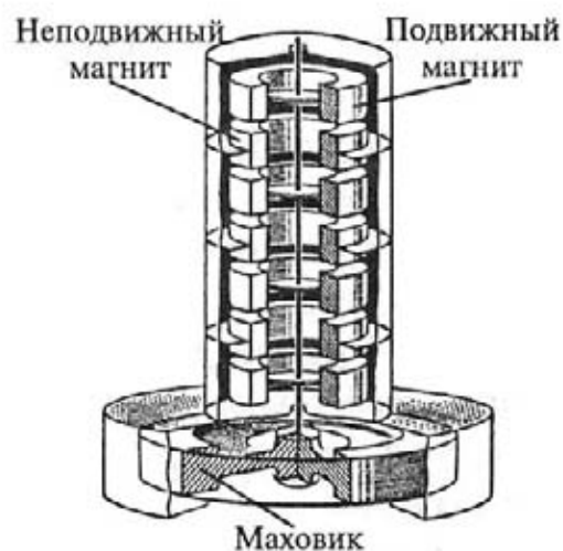
Магнитная подвеска маховика в виде «батарей» магнитов
