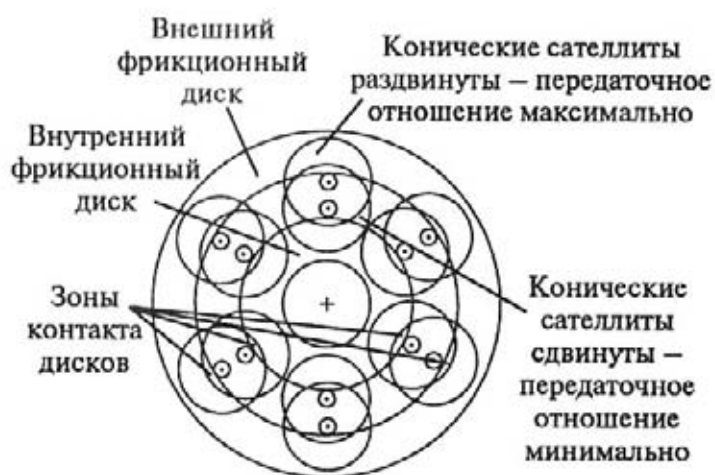
Планетарная схема дискового вариатора
