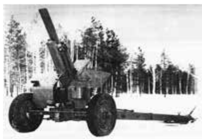
Артиллерийское орудие М-30 – 122-мм гаубица конструкции Ф.Ф. Петрова, изготовленная на Уралмашзаводе во внеурочное время на средства, собранные учителями и школьниками школы № 68
