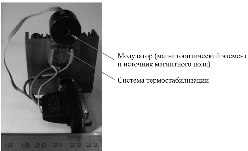
Рис. 4.17. Модулятор ИК-излучения, работающий на основе эффекта гигантского магнитопропускания в пленке \text{La}_{0.82}\text{Na}_{0.18}\text{MnO}_3
